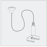
Câble de suspension. Longueur cable max 2m.
