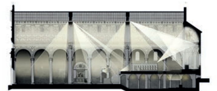
Coupe longitudinale Nouvelle conception d'éclairage
