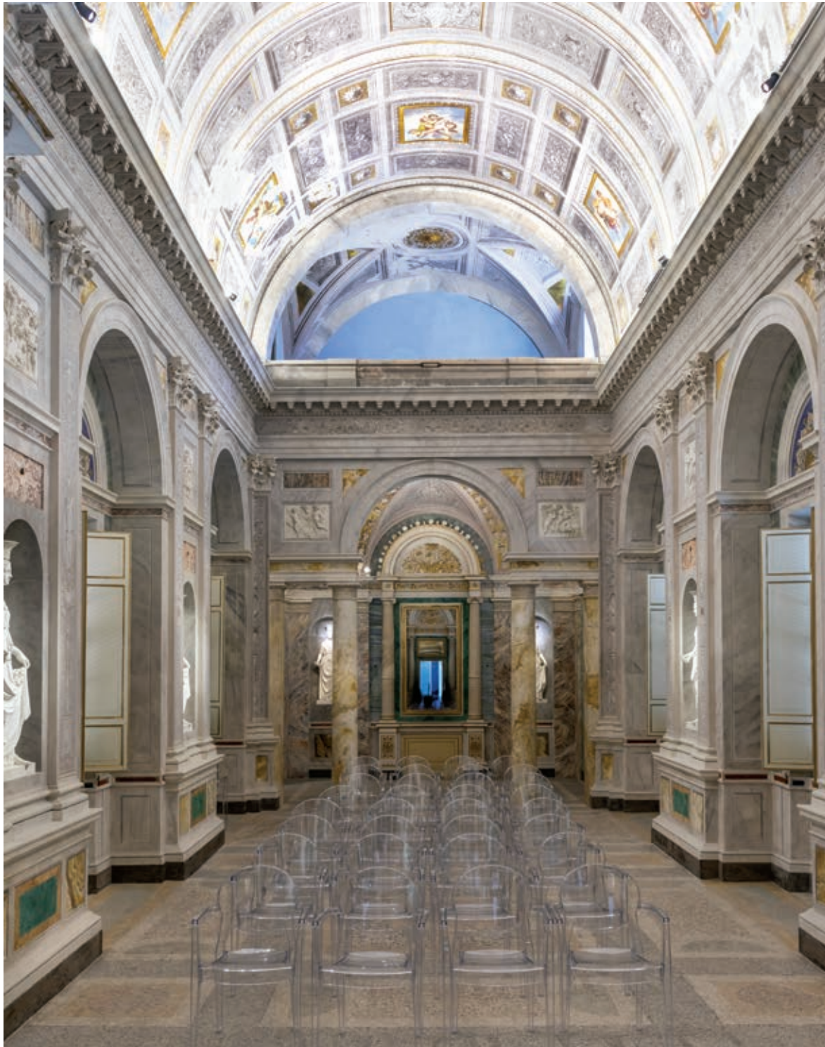
L'illuminazione della volta a botte della Galleria è realizzata con apparecchi lineari modulari posizionati sui cornicioni.
