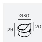
Accessorio per riduzione parziale e direzionale dell'eventuale abbagliamento, montaggio a scatto, può ruotare di 360°. Sostituisce la ghiera fornita di serie.
