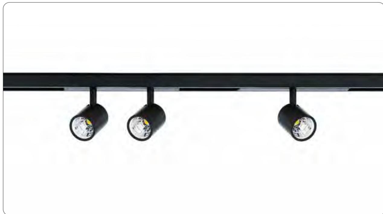
SPOT 48 est un projecteur avec 1 ou 2 spots à LED orientables de 350° sur le plan horizontal et de 90° sur le plan vertical, pour système TRACK 48 version suspension - plafond et trimless.
