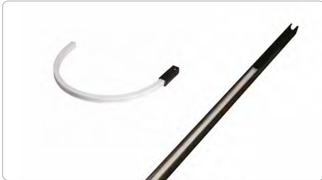
Module linéaire à lumière diffuse pour rail 48V avec un embout de connexion et l'autre extrémité libre et lumineuse. Il s'insère dans le rail, en émission directe ou indirecte, et garantit une diffusion de lumière douce avec une ouverture de faisceau transversale d'environ 120 degrés.
